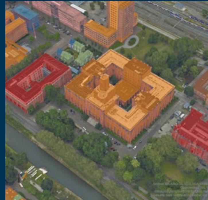
Abb. 3: Links: Visualisierung der aus dem True Ortho automatisch extrahierten Gebäudeumringe im True Ortho. Rechts: Visualisierung dieser 2D-Gebäudeumringe im 3D-Mesh.
