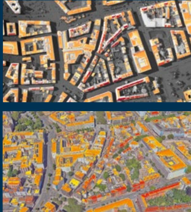
Abb. 1: Pixelgenaue Ableitung des Solarpotenzials basierend auf dem DSM. Je dunkler der Rotton, desto mehr Potenzial weist eine Fläche auf (oben). Darstellung des Solarpotenzials im 3D-Mesh. Hierbei wird das ermittelte Solarpotenziallayer direkt auf der Oberfläche des 3D-Meshes dargestellt (unten).
