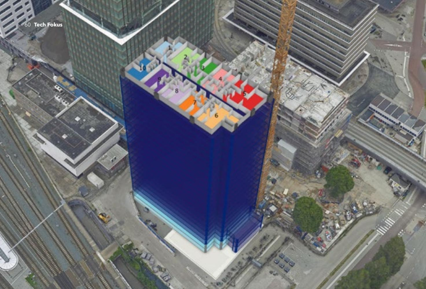
Abb. 4: Photorealistisches 3D-Mesh als Kontext, in den an die Stelle eines existierenden Gebäudes die Planung eines neuen Gebäudes inklusive Indoor Planning eingeführt wird.
